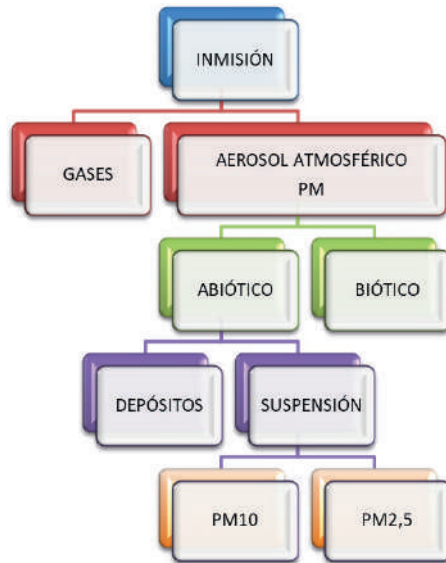
Figura 9.- Esquema de los parámetros que se estudian en las redes de vigilancia. El aerosol atmosférico biótico no ha sido objeto de regulación
