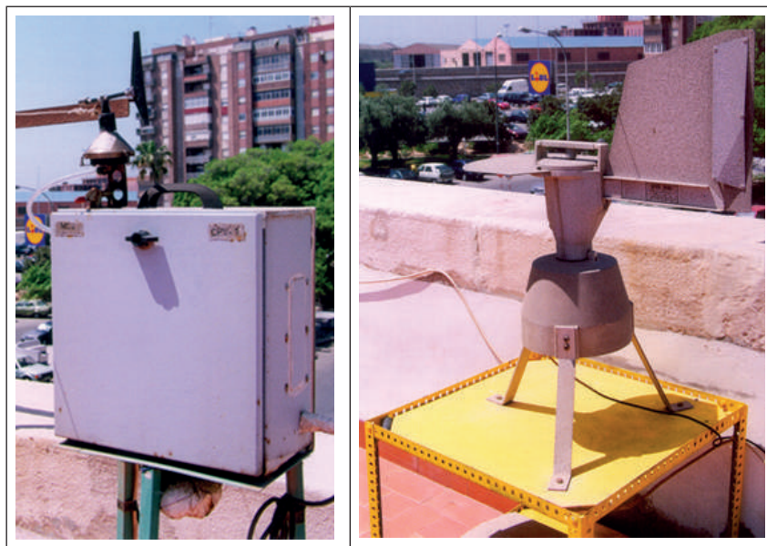
Figura 11.-a) Captador desarrollado por Suárez-Cervera y Seoane-Camba. b) Captador VPPS 2000 Lanzoni basado en el aparato desarrollado por Hirst
