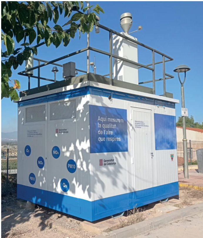
Figura 1. Estació automàtica de la Xarxa de Vigilància i Previsió de la Contaminació Atmosfèrica (XVPCA) de la Generalitat de Catalunya (Gencat 2021).
